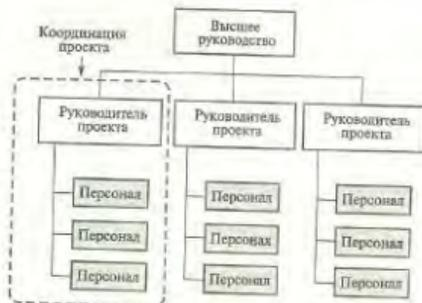
Рис. 3.4. Проектная организационная структура: затененные блоки показывают персонал задействованный в проекте
