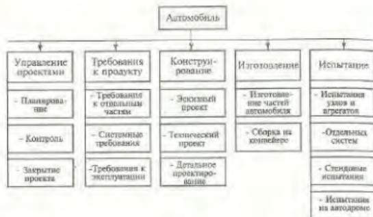
Рис. 5.4. Пример декомпозиции проекта «Создание спортивного автомобиля», ориентированной на логический аспект проекта
