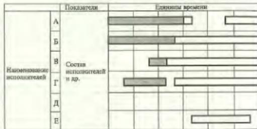
Рис. 19.1. Плывово-учетный график использования рабочей силы
